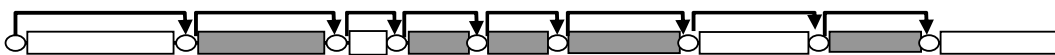
Рис.2.3. Распределение памяти. Кружки обозначают контрольный блок, белые прямоугольники – свободную память, серые прямоугольники – занятую память.
